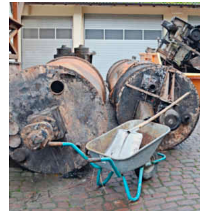
Die Walzenstühle zum Mahlen sind nach dem Brand komplett unbrauchbar.
